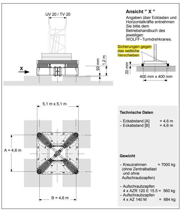
Der Kreuzrahmen wird als unabhängige Baugruppe im Rahmen des WOLFF – Turmdrehkran – Systems eingesetzt.
